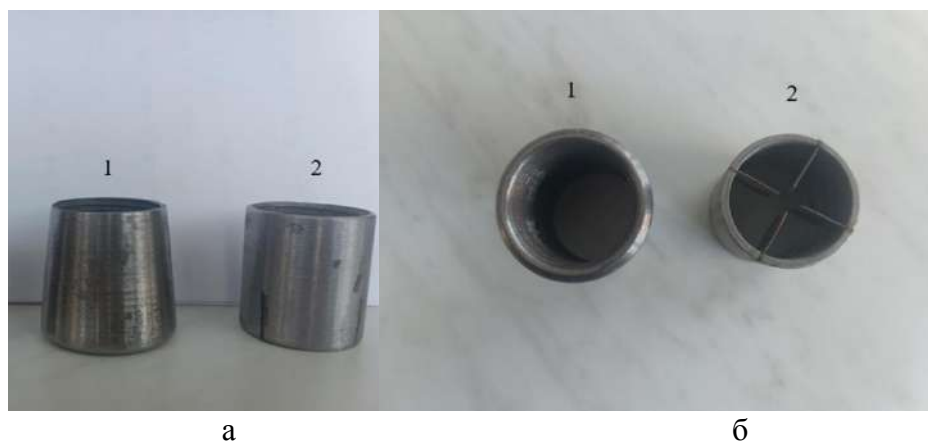
Рисунок 2 – Насадки, участвующие в эксперименте: а – вид сбоку на насадку плавного обтекания 1 и со струевыпрямителем внутри трубы 2; б – вид сверху на насадку плавного обтекания 1 и со струевыпрямителем внутри трубы 2.
