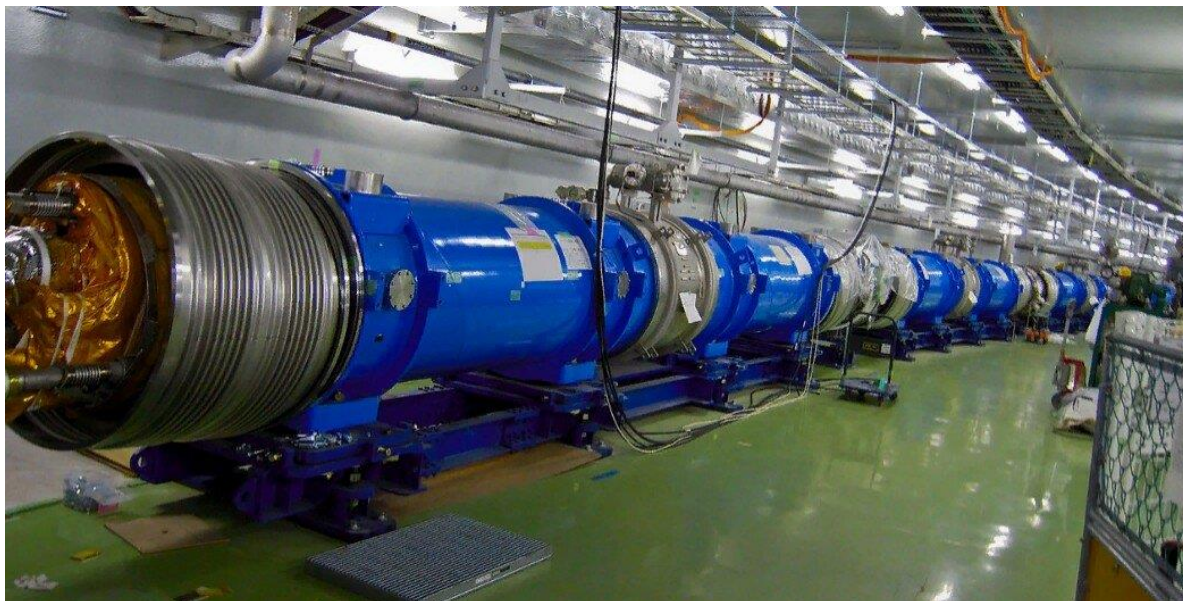
Рис. 3. «J-PARC» - Японский исследовательский комплекс с ускорителем частиц, который будет применяться в экспериментах с ADS.
