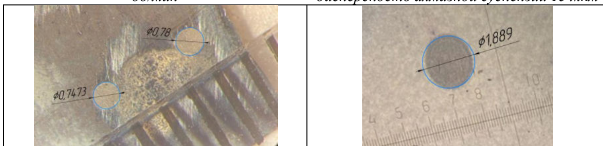
Рис. 6. Результаты истирания образца Hf , параллельные опыты, условия истирания, см. рис. 4
