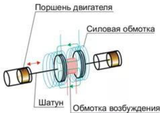
Рис. 2. Общая схема линейного генератора
