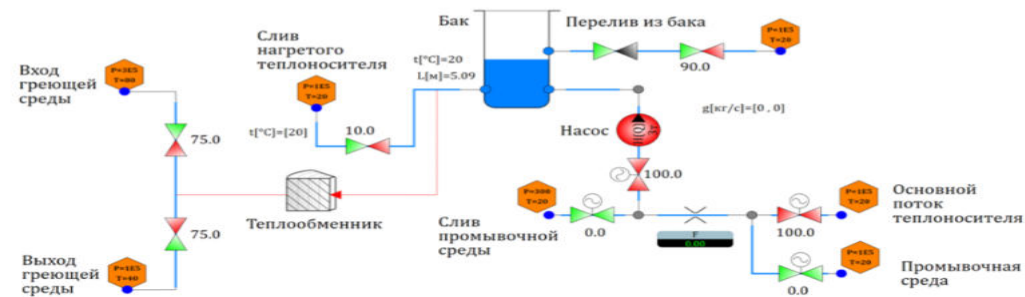
Рис. 7. Полный проект системы управления фильтрации теплоносителя
