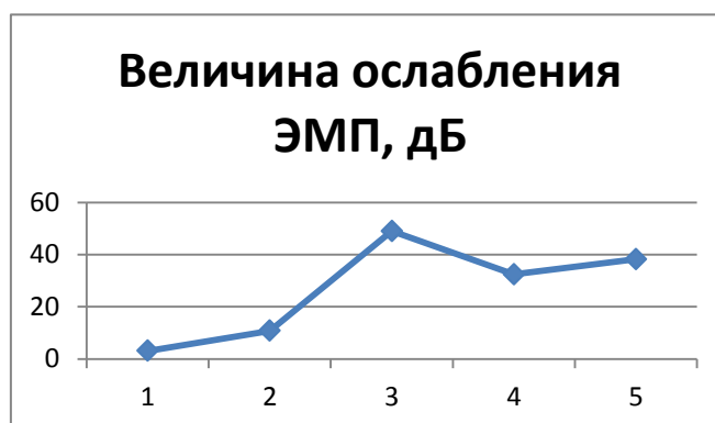
Рис. 4. График величины ослабления ЭМП образцов радиозащитного бетона
