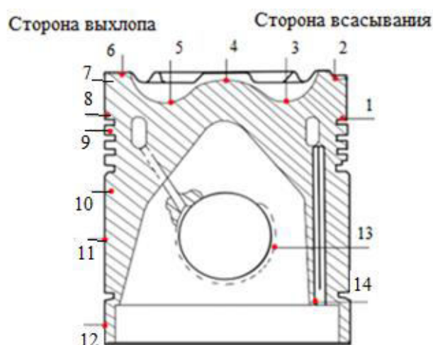
Рис. 1. Эскиз поршня с точками замера температур
