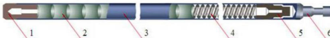
Рис. 4. ТВЭЛ реактора ВВЭР:
