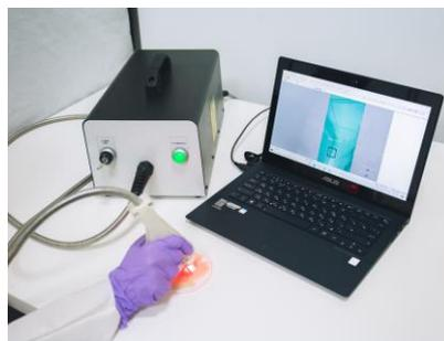
Аппарат для лазерной пайки
