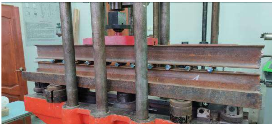
Фото 2. Испытательный стенд с металлической балкой, усиленной углеволокном
