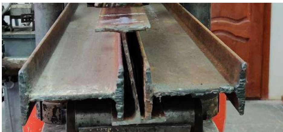
Фото 3. Испытательный стенд с испытанной балкой, усиленной углеволокном
