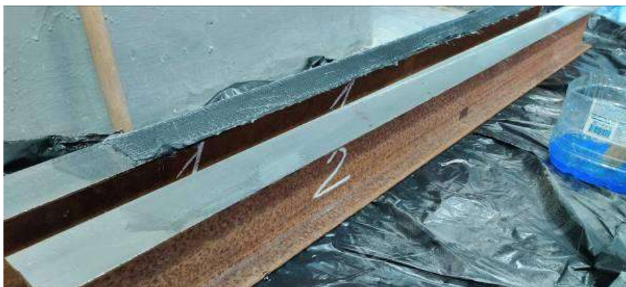
Фото 1. Образцы металлических балок: 1 - усиленная углеволокном; 2 - неусиленная
