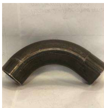
Рис. 8.1, 8.2. Результаты гибки трубы диаметром 57 мм
