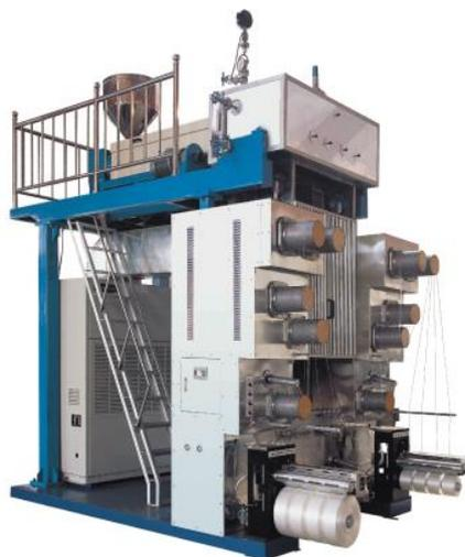
*Рис. 1. Линия для производства полипропиленовых нитей серии FDY*
