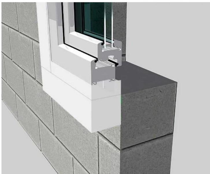
*Рис. 2. Конструкция выносного монтажа*
