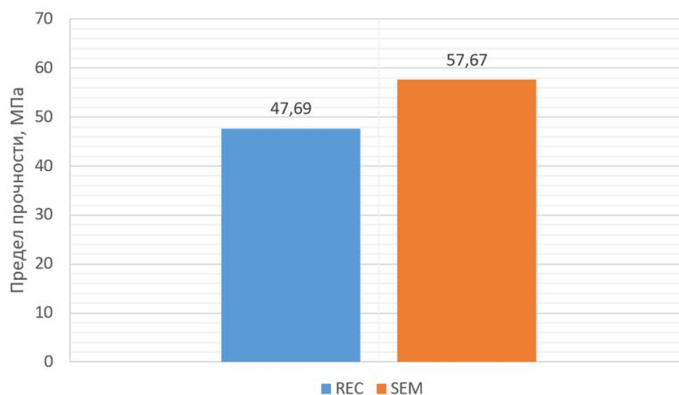
*Рис. 3. Сравнительная характеристика прочности образцов на разрыв в зависимости от производителя филамента*
