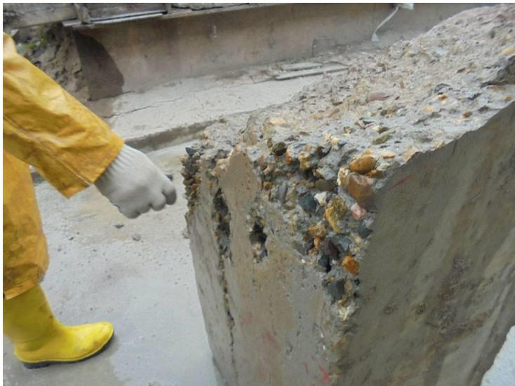
*Рис. 6. Разрушение бетонного образца от действия ионизирующего излучения*
