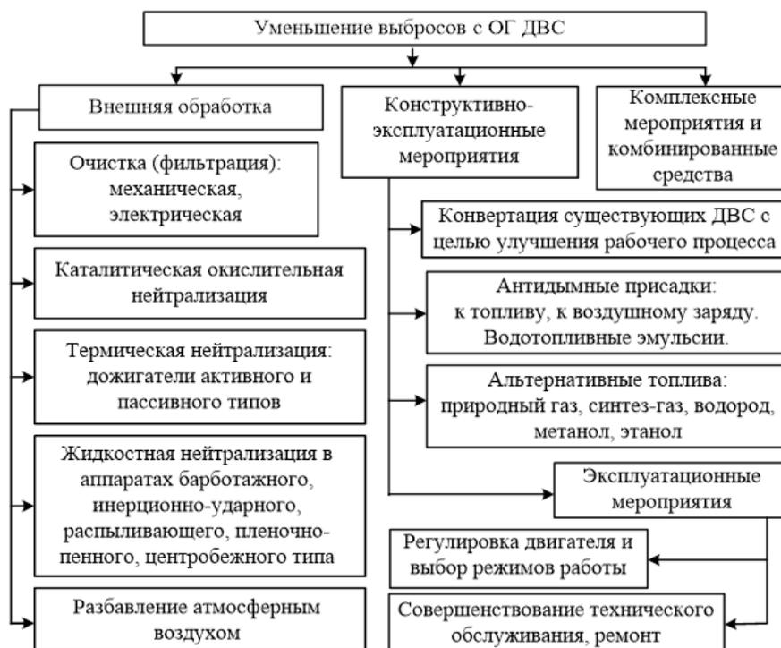
Рис. 2. Основные технологии снижения вредных выбросов с ОГ ДВС
