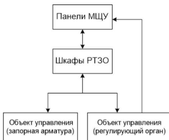
*Рис. 2. Состав оборудования системы ДУ и индикации состояния электроприводами запорной и регулирующей арматуры (управление с МЩУ)*
