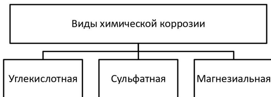
*Рис. 2. Виды химической коррозии*
