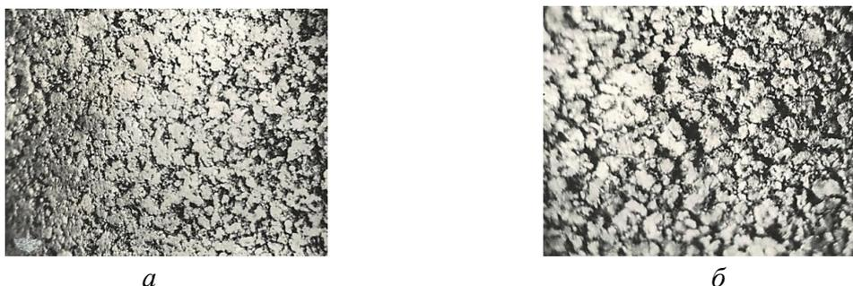
Рис. 1. Состояние периферийной поверхности порошкового образца до (а) и после (б) осадки ( $\times 30$ )
