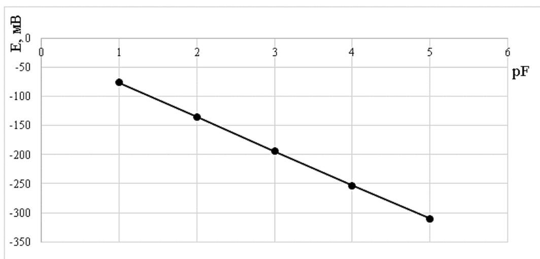
Рис. 1. Зависимость потенциала фторид-селективного электрода от  $\text{pF}^- = -\lg CF^-$
