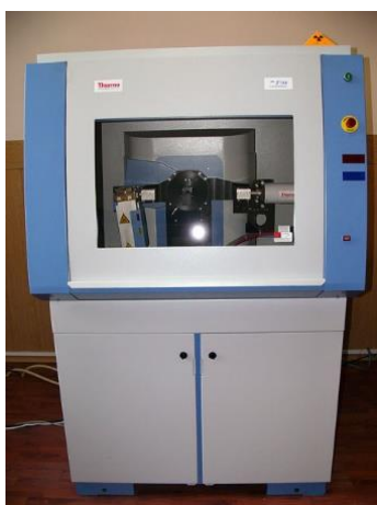
Рис. 8. Дифрактометр ARL X'TRA «Thermo Fisher Scientific»
