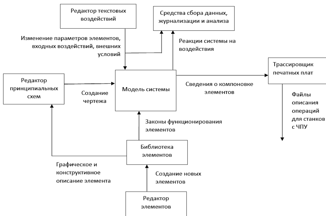
Рис. 1. Обобщенная структура САПР электронных устройств
