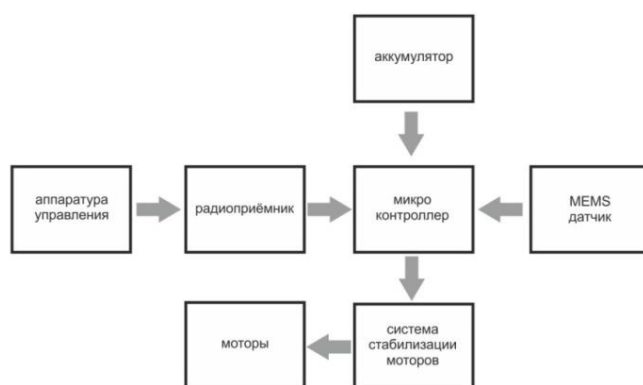
Рис. 1. Функциональная схема квадрокоптера
