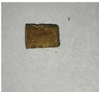
*Рис. 5. Образец стали марки Ст3сп после пребывания в дистиллированной воде*
