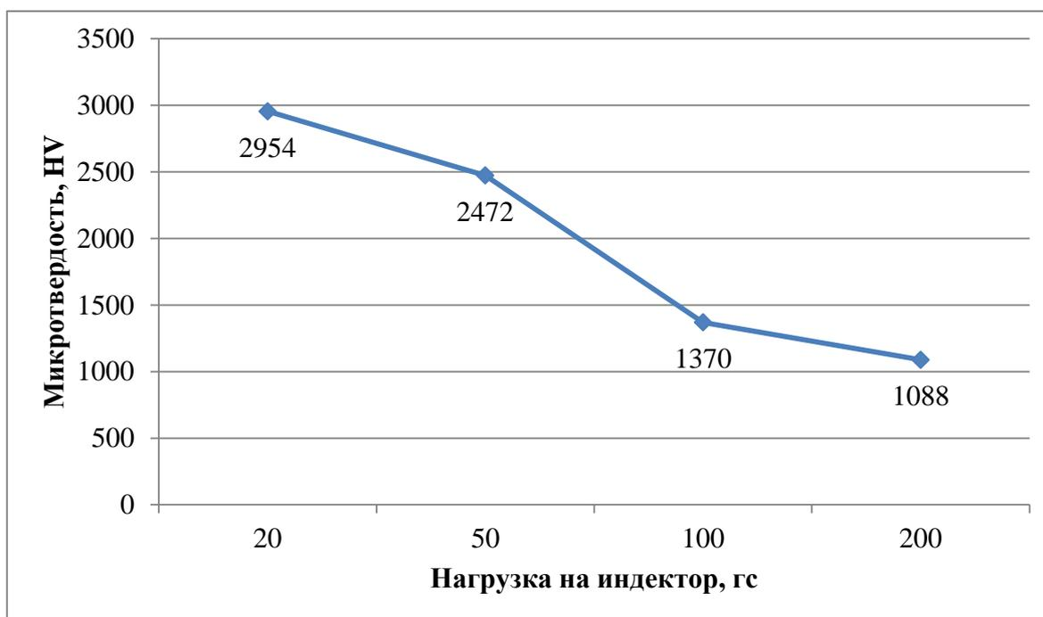
*Рис. 5. График твердости образца из медицинской стали 12Х18Н10Т с покрытием та-С при изменении нагрузки на индентор*
