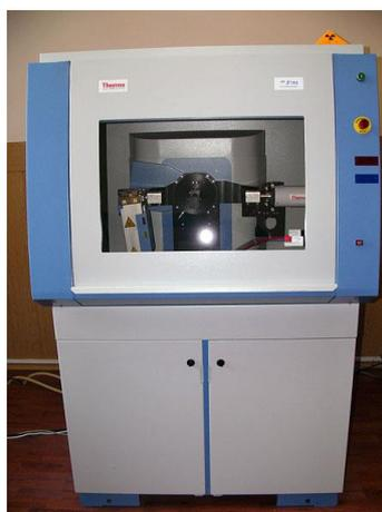
Рис. 4. Дифрактометр ARL X'TRA «Thermo Fisher Scientific»
