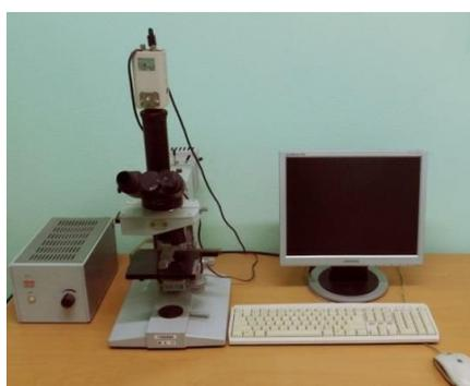
Рис. 3. Металлографический микроскоп АГПМ–6М
