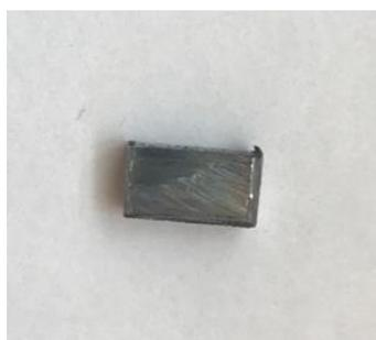
*Рис. 6. Образец стали марки Ст3сп после пребывания в водном растворе Рофамина Т (0,1 мг/мл)*
