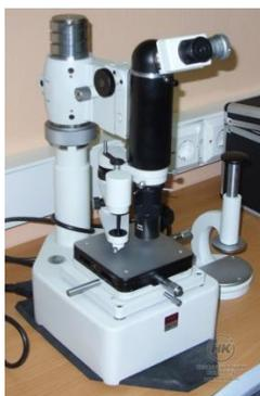
*Рис. 6. Микротвердомер ПМТ-3М*
