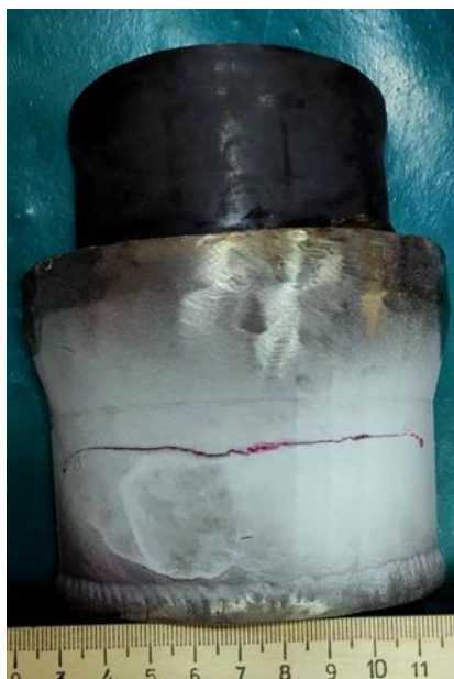
Рис. 1. Трещина основного металла патрубка
