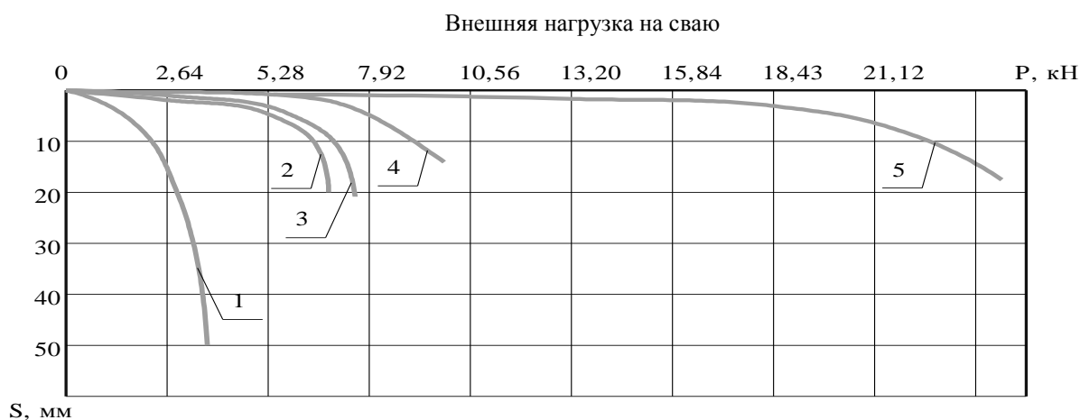
Рис. 4. Результаты лабораторных испытаний модели свайного фундамента без преднапряжения и с преднапряжением по боковой поверхности; рабочая длина сваи H = 1300 мм, D = 76 мм:
