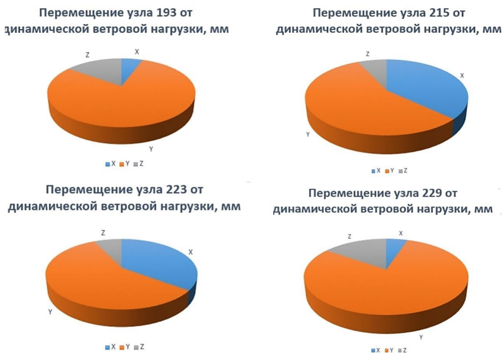
Рис. 5. Диаграммы перемещения характерных узлов по осям при динамической ветровой нагрузке
