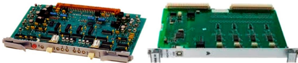
Рис. 4. Внешний вид блока управления задвижкой (БУЗ): а – блок в 1990-х годах; б – блок в 2000-х годах
