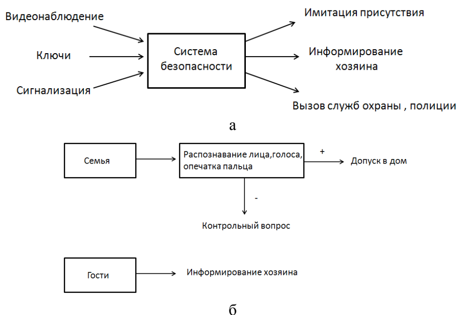
Рис. 2. Система безопасности дома где: а – схема концепции безопасности; б – система доступа в дом доверенных и посторонних лиц
