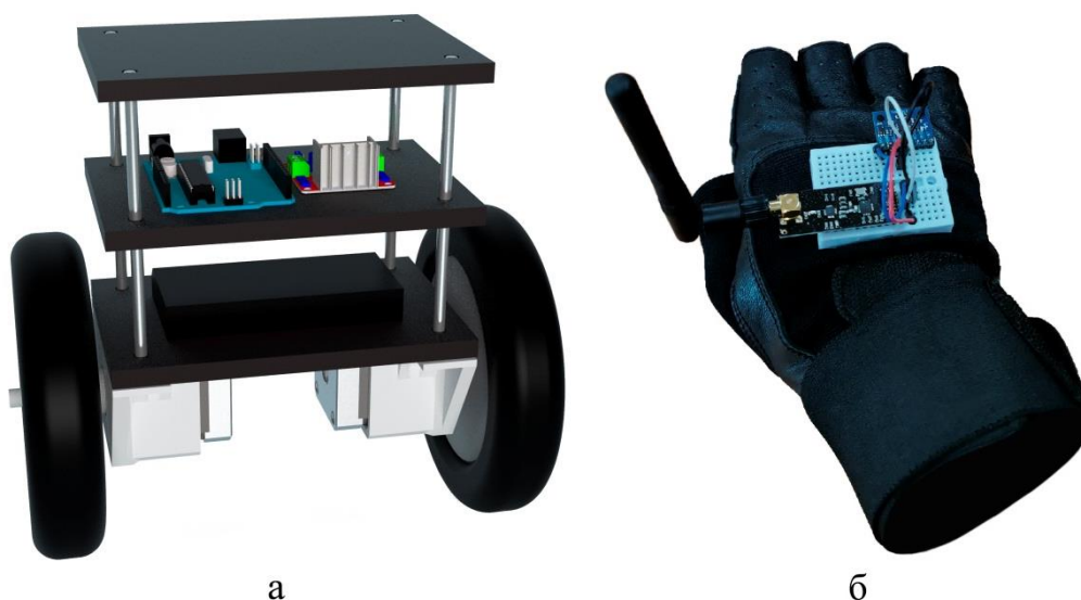
Рис. 3. Компоненты дистанционно управляемой мобильной платформы: а – робот-балансир; б – управляющая перчатка
