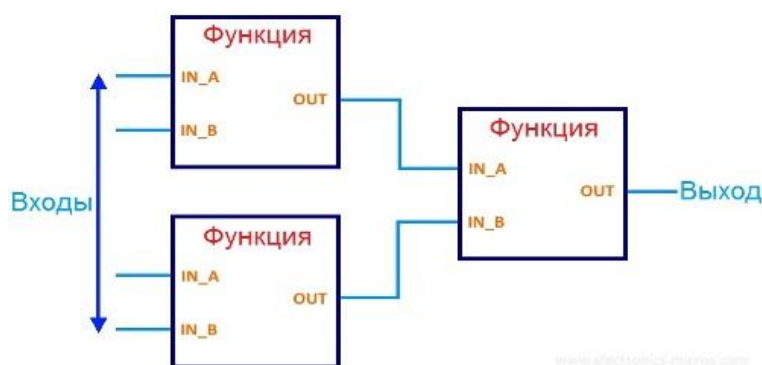
Рис. 1. Пример программы с использованием языка FBD
