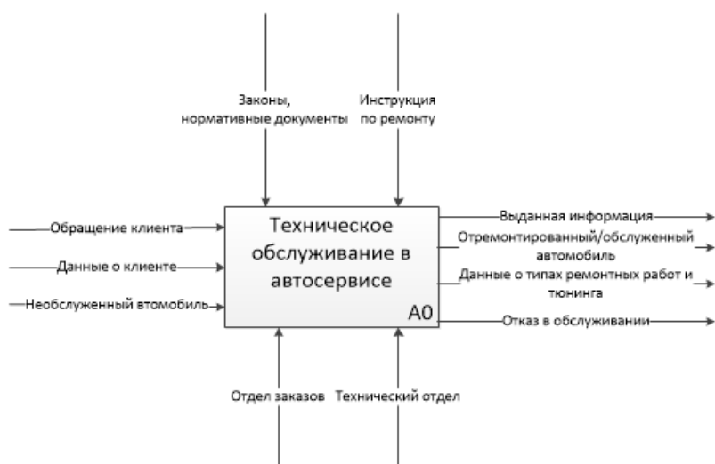
Рис. 1. Контекстная диаграмма процесса «Техническое обслуживание в автосервисе»
