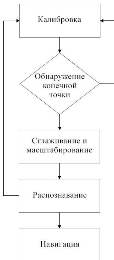
Рис. 2. Блок-схема алгоритма управления с помощью жестов
