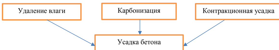
Рис. 1. Процессы, приводящие к усадке бетона
