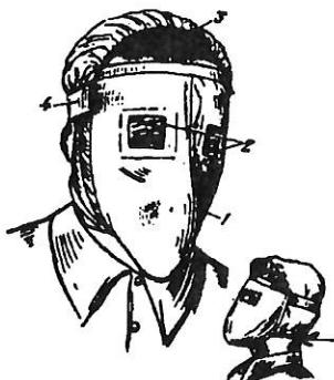
Рис. Противопыльная тканевая маска ПТМ-1:
