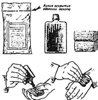
Рис. 3. Индивидуальный противохимический пакет ИПП-8 и пример пользования им.
