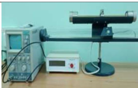
Лабораторная установка «Определение скорости пули при помощи баллистического маятника»
