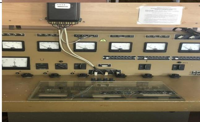
**Стенд У1134М «Измерение активной мощности трехфазных токов»**
