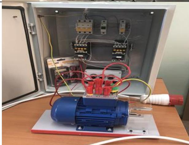
**Набор для монтажа в комнате электромонтажника схем управления трёхфазным асинхронным двигателем с короткозамкнутым ротором»**
