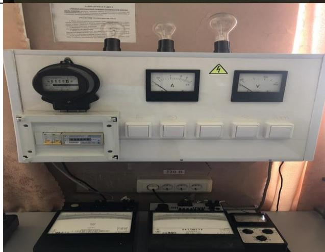
**Лабораторная установка «Устройство и работа индукционного и электронного счетчиков электрической энергии»**
