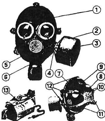
В комплект противогаза ГП-7 входят: 1 — лицевая часть; 2 — фильтрующе-поглощающая коробка; 3 — трикотажный чехол; 4 — узел клапана вдоха; 5 — переговорное устройство (мембрана); 6 — узел клапанов выдоха; 7 — обтюратор; 8 — наголовник (затылочная пластина); 9 — лобная лямка; 10 — височные лямки; 11 — щечные лямки; 12 — пряжки; 13 — сумка.
