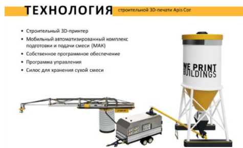
Рис. 7. Схема ApisCor технологии
