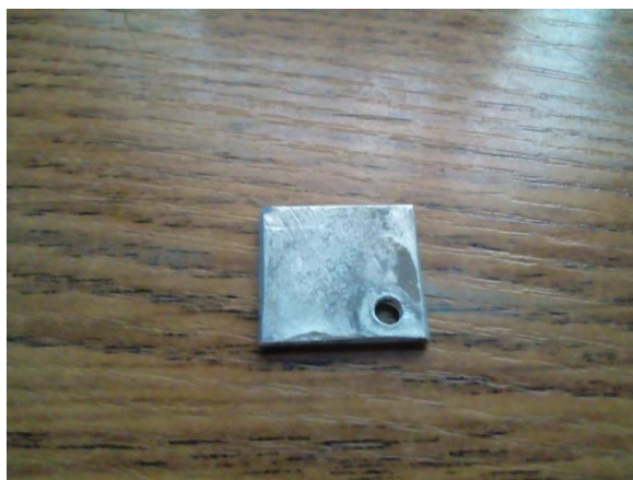
Рис. 1. Образец силумина АК12
