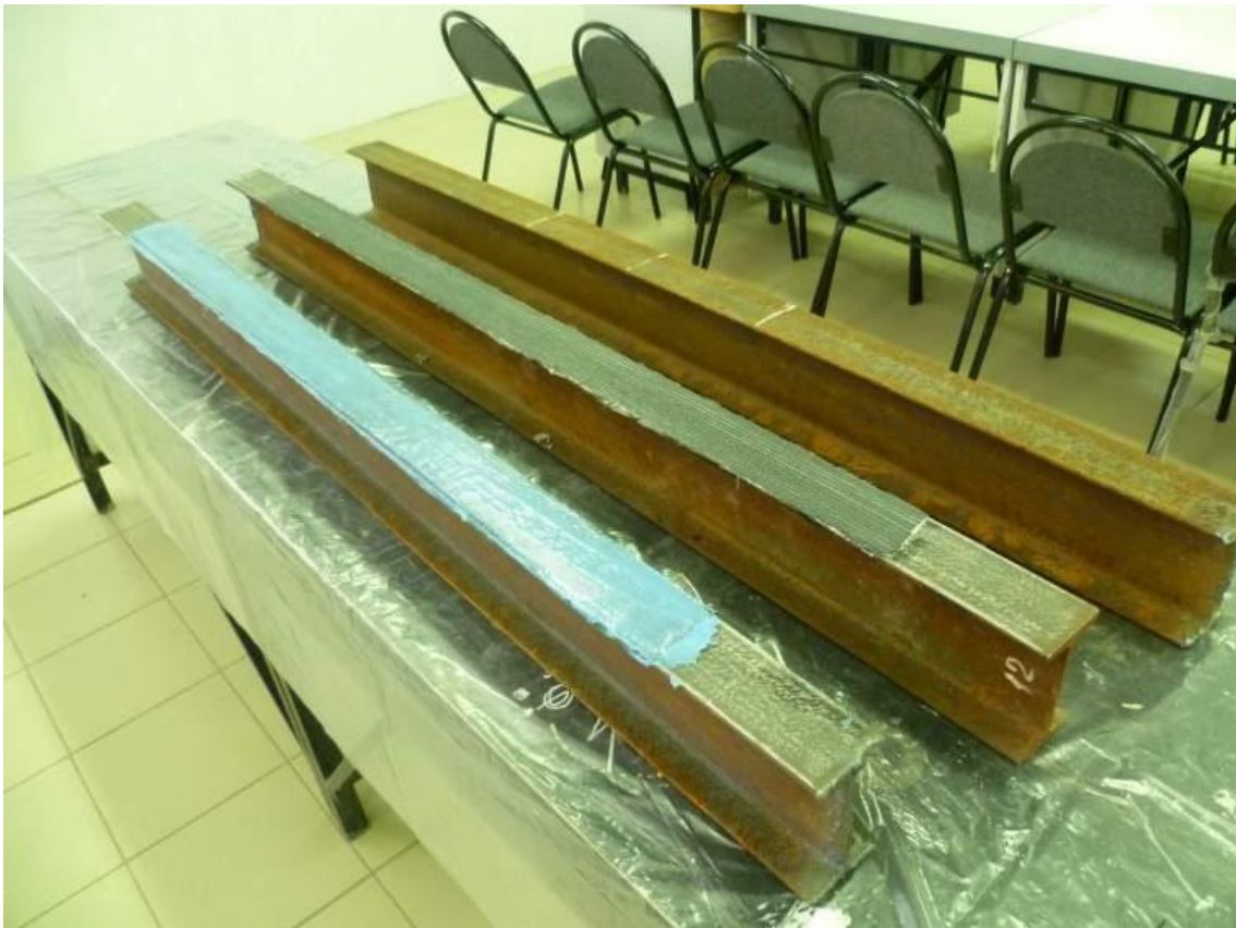
Фото 1. Образцы металлических балок, усиленных и не усиленных углеволокном
