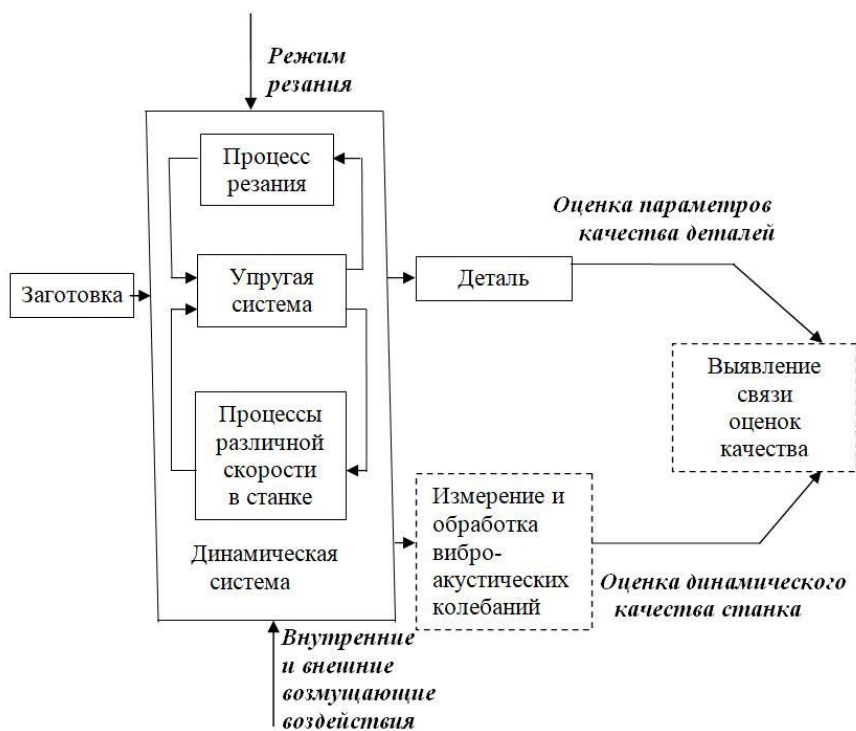
Рис. 1. Оценка технологической надежности автоматизированного станка на основе выявления связи его динамического качества со значениями параметров качества деталей
