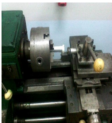
Размещение образца и оснастки на станке ТВ-4
