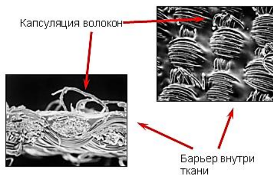
Рис. 5. Технология обработки ткани силиконом
