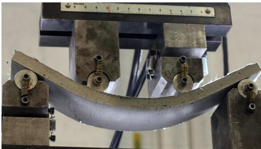
Рис. 2. Испытание самовосстанавливающегося бетона на изгиб
