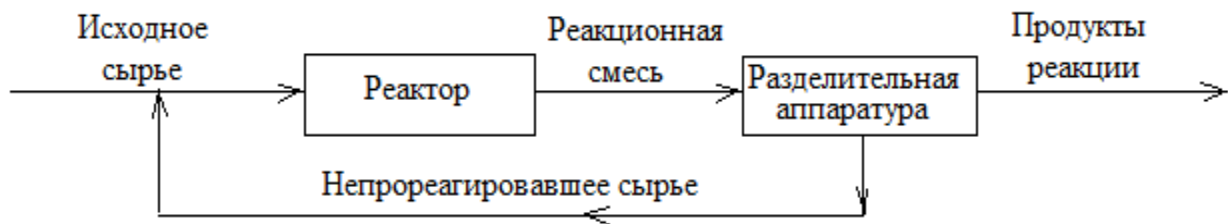
Рис. 1. Связь реактора с разделительной аппаратурой в технологической схеме
