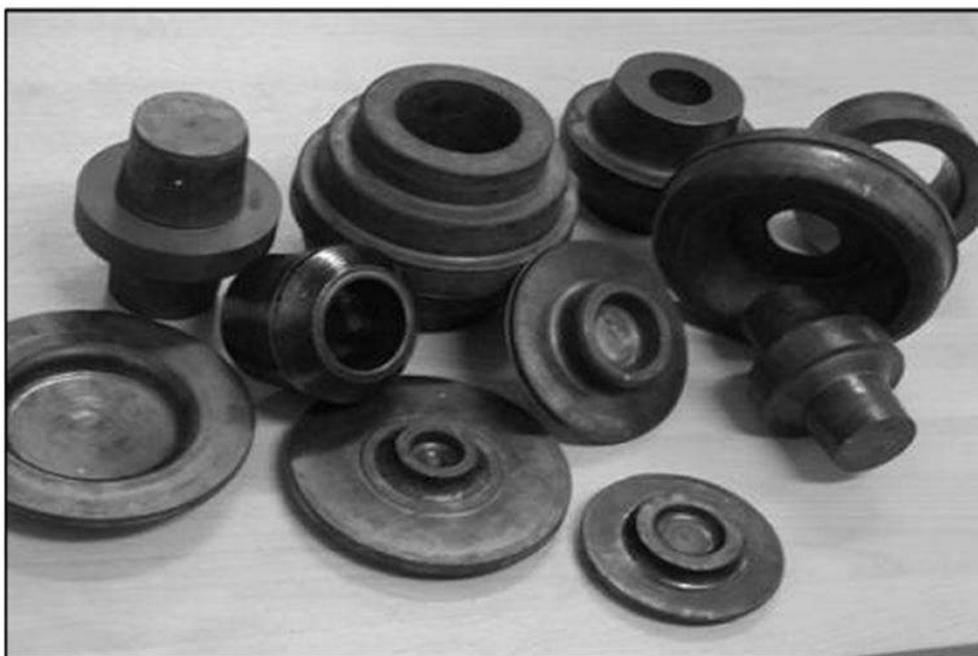
*Рис. 2. Детали, изготовленные раскаткой*
