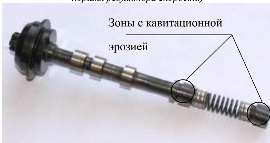
*Рис.2. Усталостное выкрашивание поверхностного слоя прецизионной детали (золотника регулятора скорости)*
