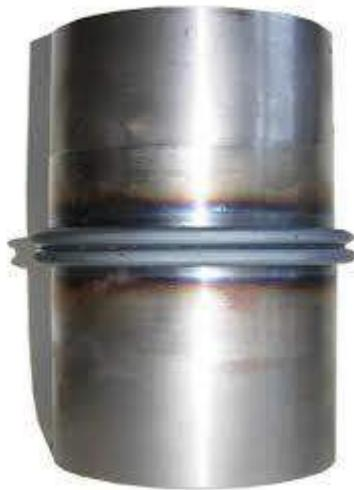
*Рис. 4. Соединение, полученное сваркой трением*
