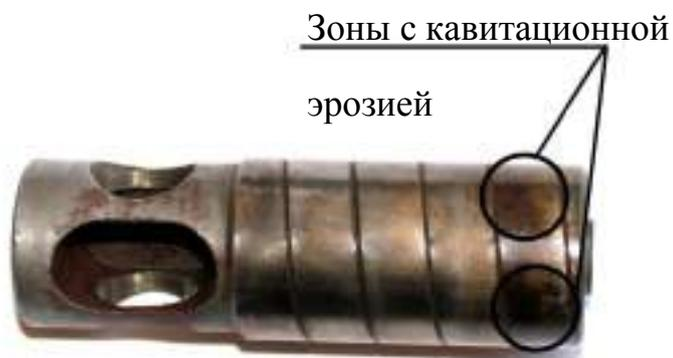
*Рис.1. Усталостное выкрашивание поверхностного слоя прецизионной детали (нижнего поршня регулятора скорости)*
