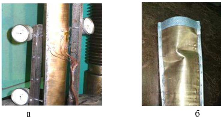
Рис.2. Модель полого стержневого элемента: а – схема расположения приборов; б – модель после испытания
