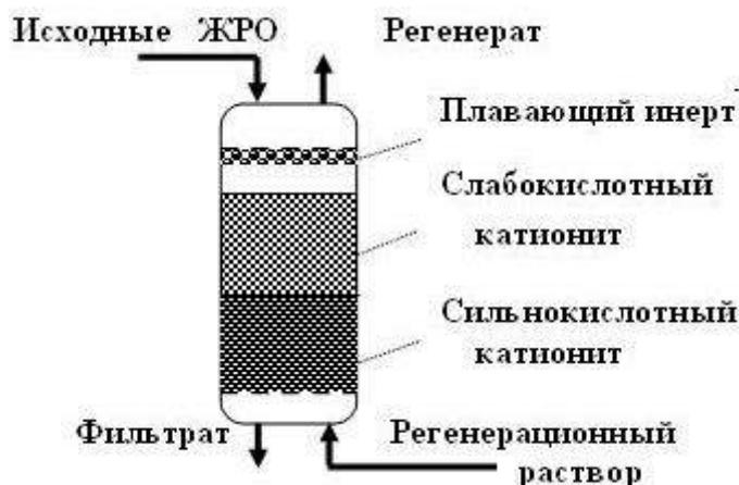
Рис. 8. Схема послойного расположения слабокислотного и сильнокислотного катионитов в одном аппарате
