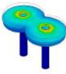
Рис.3. Напряжение по Мизесу, min 5.677 МПа, max 5.948 МПа
