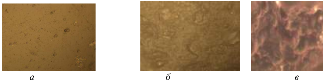
Рис. 2. Оптическая микроскопия пленок ЭВА разных производителей \times 100 .
