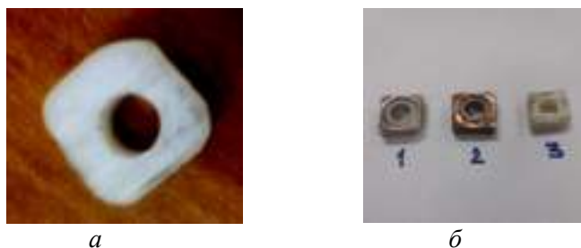
Рис.1. Исследуемые образцы: а – СВМПЭ до истирания, б – образцы акрилата Р 5.3 после истирания
