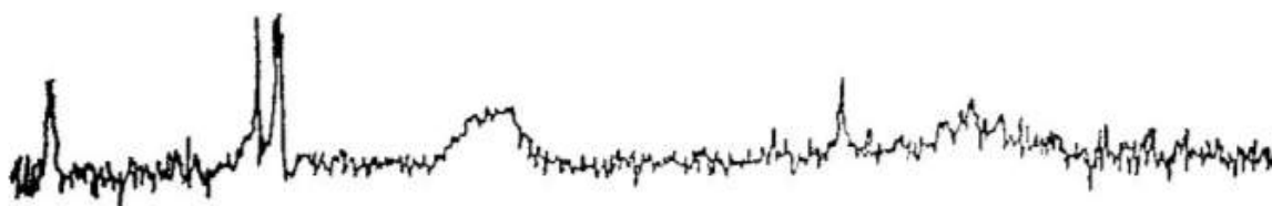
Рис. 6. Спектр искусственно приготовленной трехкомпонентной смеси при температуре 90 0 С
