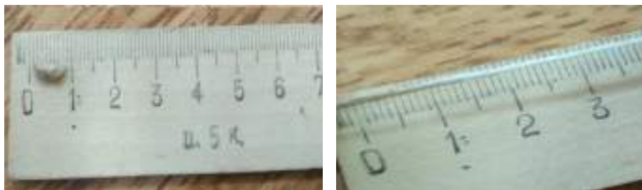
Рис. 2. Испытание резины на растяжение: а — образец резины до растяжения; б — образец резины после растяжения
