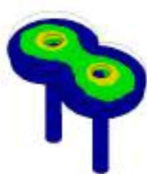
Рис.2. Статическая деформация, отн. ед., min 1.5, max 15
