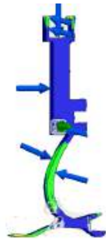
Рис.6.Ti-6Al-4V, смещение, min 0, max 1.408 мм
