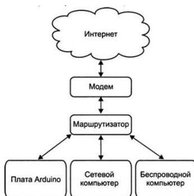
Рис. 3. Схема управления платой Arduino через интернет
