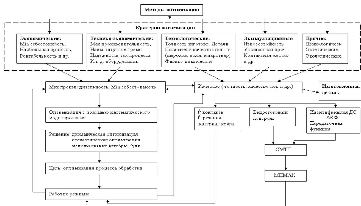
Рис. 1. Методы оптимизации процессов резания
