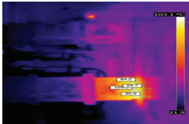
*Рис. 5. Теплограмма выходного узла редуктора тока*
