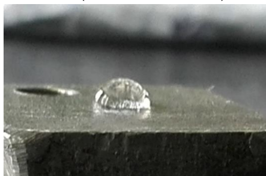
Рис.5. Образец, подвергавшийся пассивации в растворе электролита 2 ( t=40 мин. \Theta=95^\circ )
