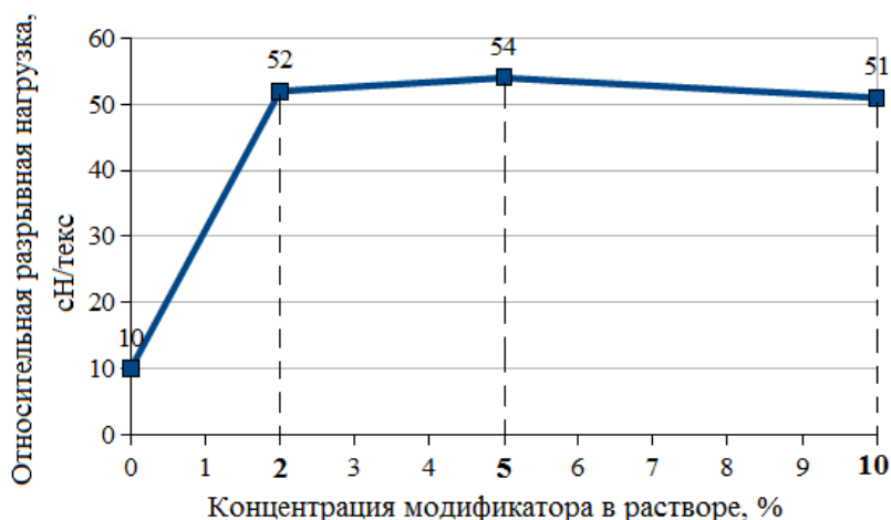
Рис. 2. Зависимость относительной разрывной нагрузки ГЦТН от концентрации соли в растворе при времени модификации 60 с
