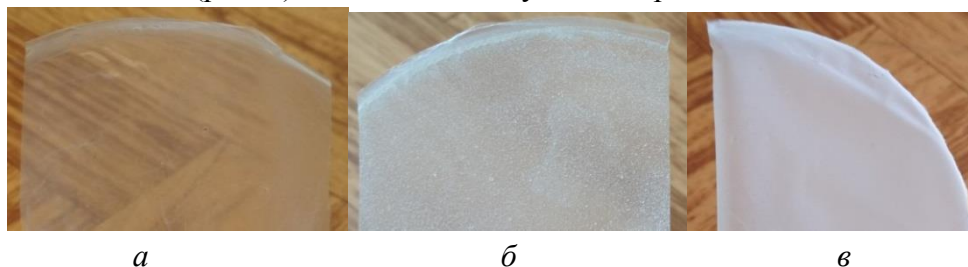
Рис. 2. Пленки полимерного композиционного материала: а) полилактид, б) полилактид и гидроксиапатит, в) полилактид и волластонит.
