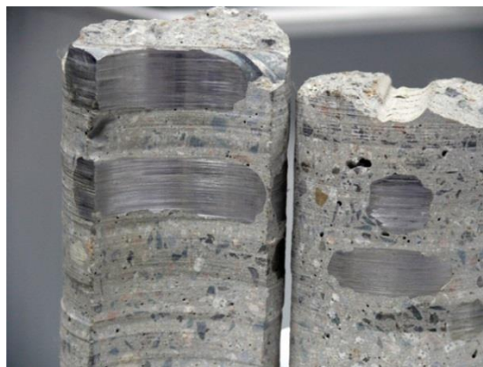
Рис.4. Фибробетон в разрезе
