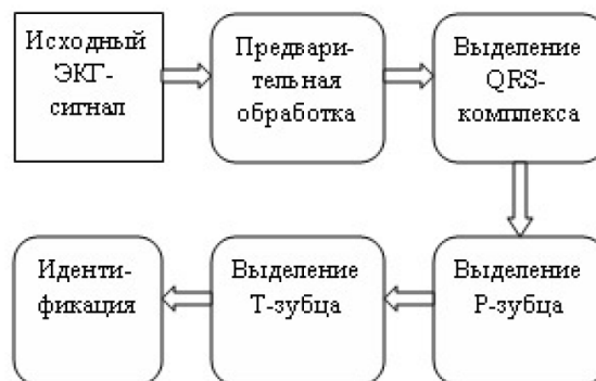
Рис. 2. Структура обработки ЭКГ-сигнала
