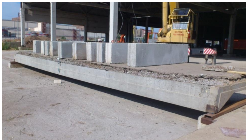
Рис. 2. Последовательность загрузки плиты
