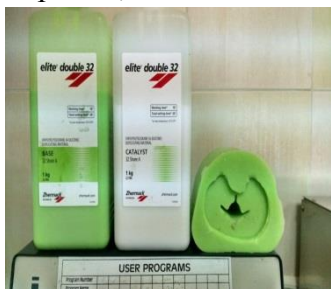
Рис.6. Силиконовая форма и компоненты для ее изготовления
