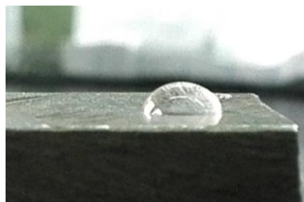
Рис.3. Образец, подвергавшийся пассивации в растворе электролита 2 ( t=15 мин. \Theta = 100^\circ )
