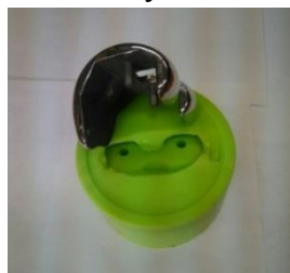
Рис.4. Силиконовая форма и бедренный компонент
