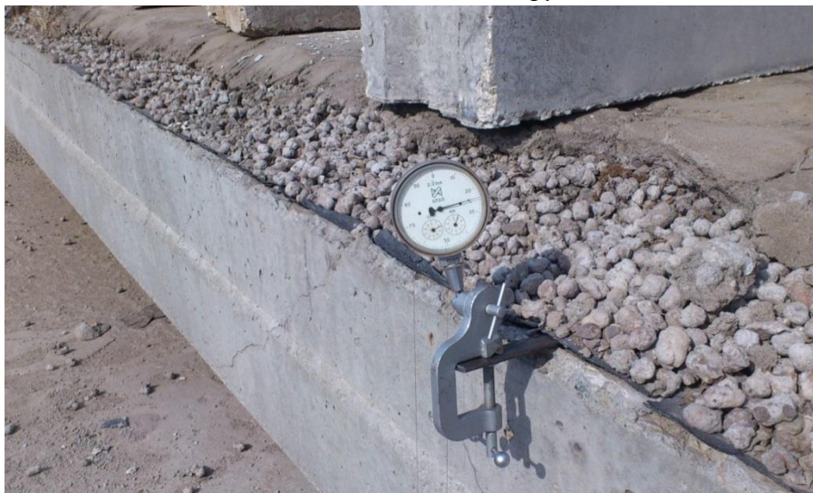
Рис. 3. Схема измерения прогибов плиты в ходе испытания
