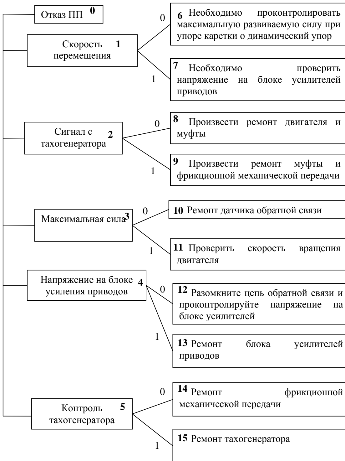
Рис.6. Функциональная модель базы знаний: ПП – подсистема привода подач
