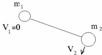
плоской поверхности. В некоторый момент скорость одной шайбы равна нулю, а другой  $V_1$ , причем ее направление перпендикулярно нити. Найти скорость центра масс системы  $V_c$ , положение центра масс  $X$  (расстояние от массы 2) и силу натяжения нити  $T$ .
